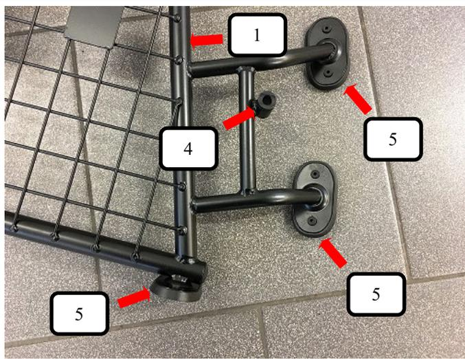
Gummifuß (Pos. 5) auf das Trenngitter (Pos. 1) und Kunststoffhülse (Pos. 4) in das Trenngitter (Pos. 1) stecken. Danach das Trenngitter (Pos. 1) von Kofferraum aus in das Fahrzeug einbringen.
